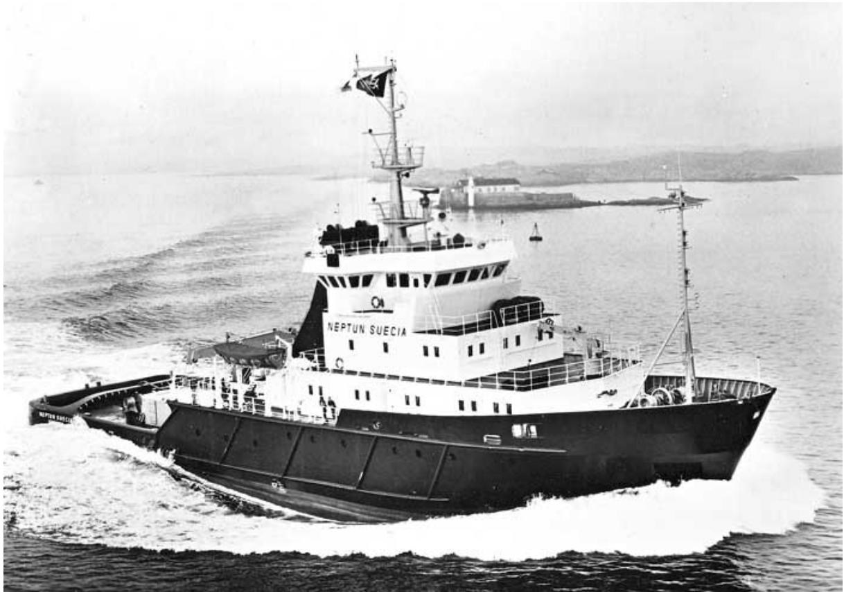
Les essais en mer du Neptun Suecia bientôt Abeille Flandre, creuse son sillon à 16 nœuds sur 4 moteurs. 1977, @Neptun Transport
