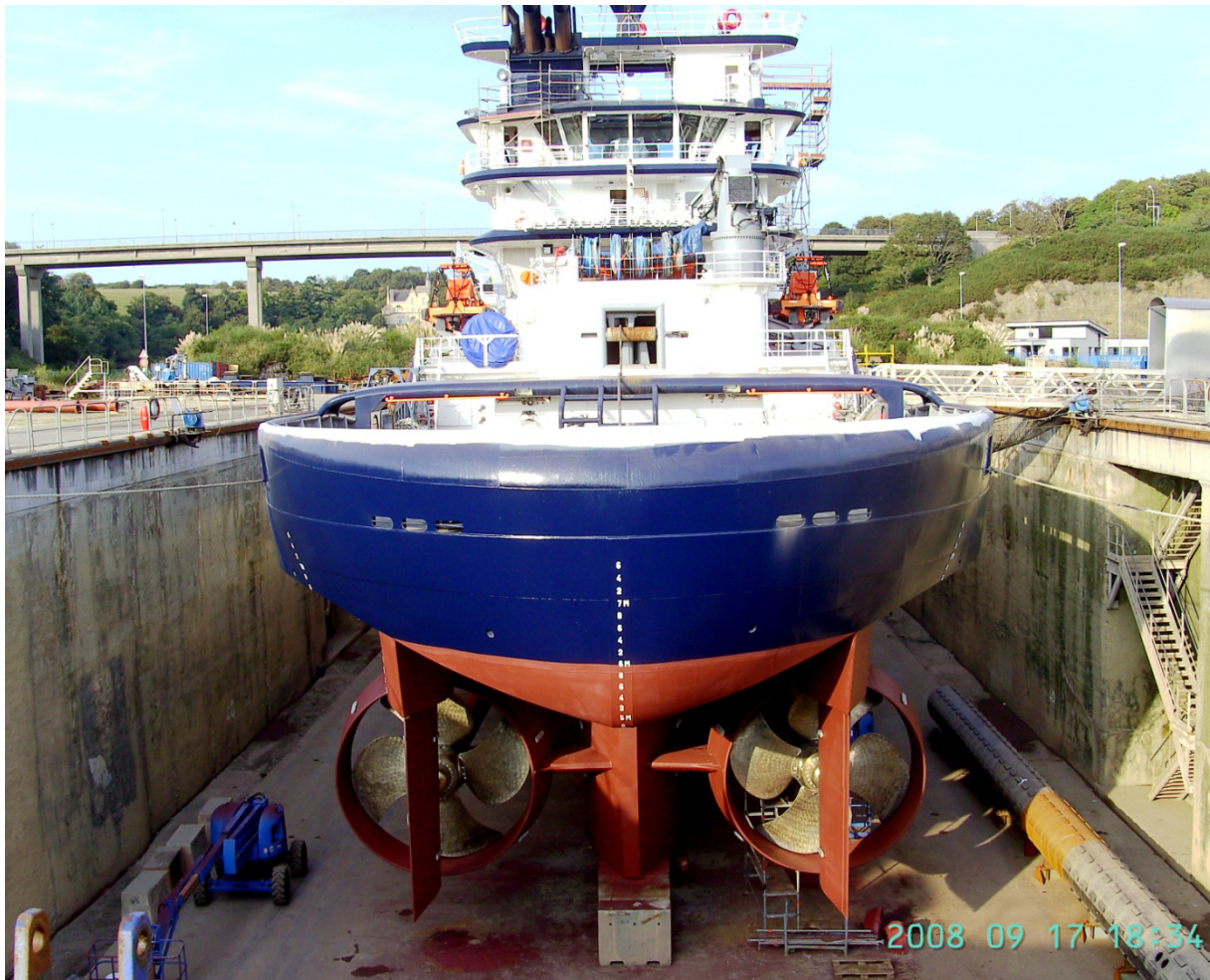
L'Abeille Liberté en cale sèche à Concarneau, les hélices et leur tuyères 2008, @Stéphane Delzenne
